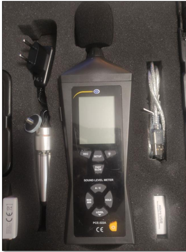
Σχήμα 2.2.3-1: Ηχώμετρο για την καταγραφή θορύβου στα εργοτάξια.
